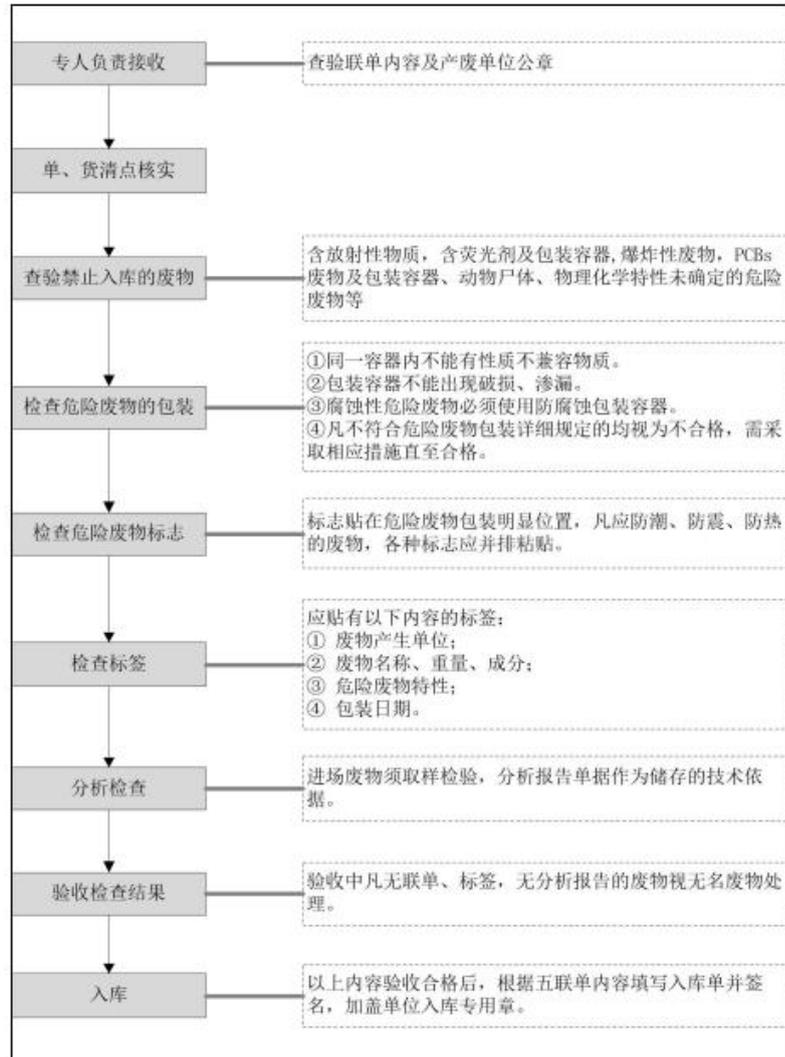
图 2.2.7-2 危废接收程序示意图
